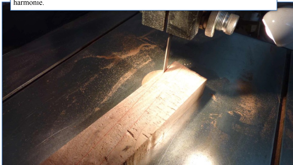
Les lattes sont délignées dans un bloc de 80 X 2,7 X 5,5 cm. D'abord dans le sens du premier calque, puis dans le plan frontal avec le deuxième. Ensuite elles seront sculptées.
