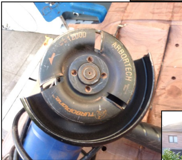
Ce gabarit voit la sculpture du creux concave du siège grandement simplifiée.
