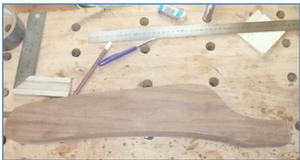
Le guide à reproduire qui positionne l'axe et le pied avant
