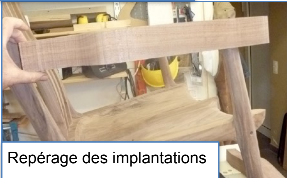
Le guide à reproduire qui positionne l'axe et le pied avant
