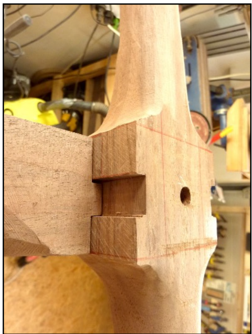
Repérage des centres de tournage, bord supérieur des pieds G et D - pour tournage excentrique
