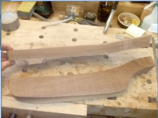
Le creux est tracé au tiers postérieur, sur un bloc parfaitement orthogonal de 5,5 à 6 cm d'épaisseur. Les morceaux de découpe sont reposés, au collant gris, pour garder la stabilité sur la machine.
