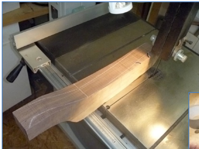
Le creux est tracé au tiers postérieur, sur un bloc parfaitement orthogonal de 5,5 à 6 cm d'épaisseur. Les morceaux de découpe sont reposés, au collant gris, pour garder la stabilité sur la machine.
