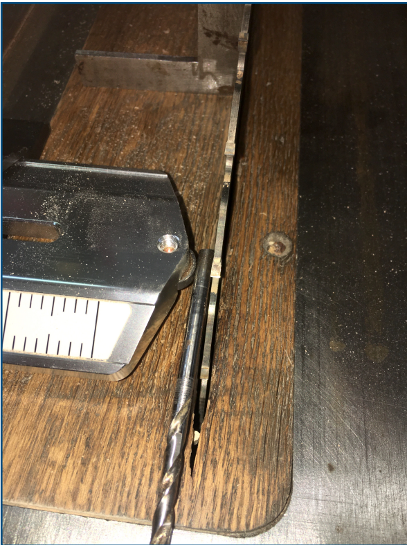
Réglage de l'épaisseur de la découpe avec une mèche de 5 mm de diamètre.
