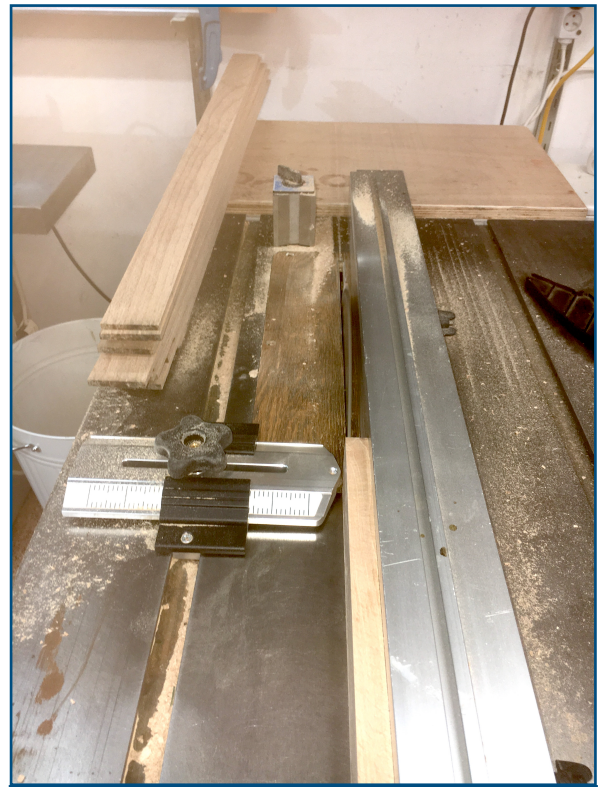
Sur une pièce parfaitement débitée orthogonale en raboteuse-dégauchisseuse la découpe des 14 lattes se fait assez vite.
